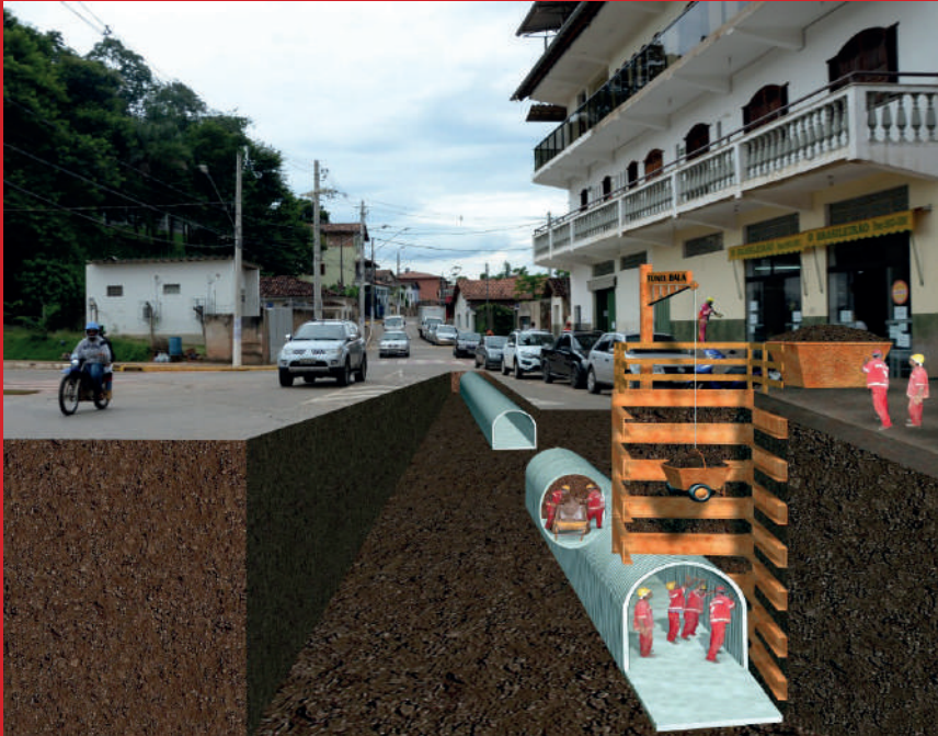
Túnel-bala vai garantir escoamento das águas de chuvas
